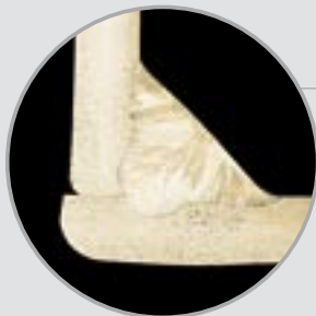
Inomaxx® 2 MAG staande hoeklas in 3 mm dik AISI 316L roestvast staal
