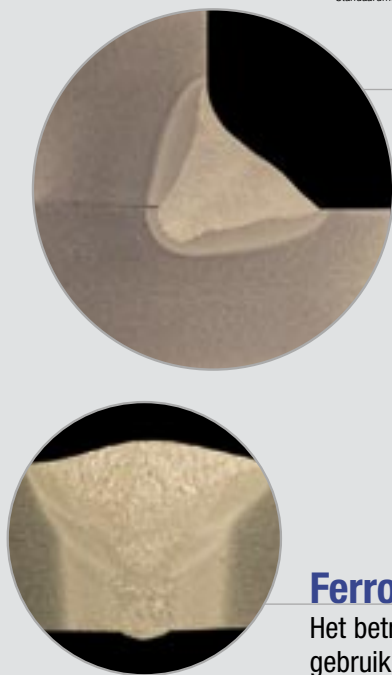
Ferromaxx® 15 MAG stompe lasverbinding in 12 mm staaldikte
